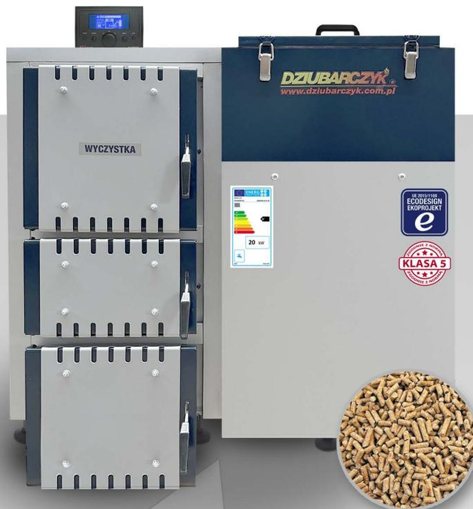
Kotły **DRAGON PRIME** o mocy 10-25kW są urządzeniami grzewczymi, niskotemperaturowymi i przeznaczonymi do podgrzewania wody w układzie centralnego ogrzewania do temperatury na wyjściu z kotła nie przekraczającej 85 °C i ciśnieniu maksymalnym wynoszącym 2 bar. Znajdują one zastosowanie w instalacjach centralnego ogrzewania i ciepłej wody, zarówno w układach grawitacyjnych jak i pompowych.
